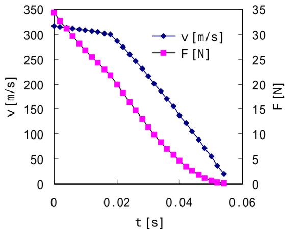
図 1.1 噴出速度と推進力の変化
