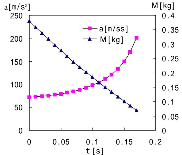
図4 ロケットの質量と加速度
