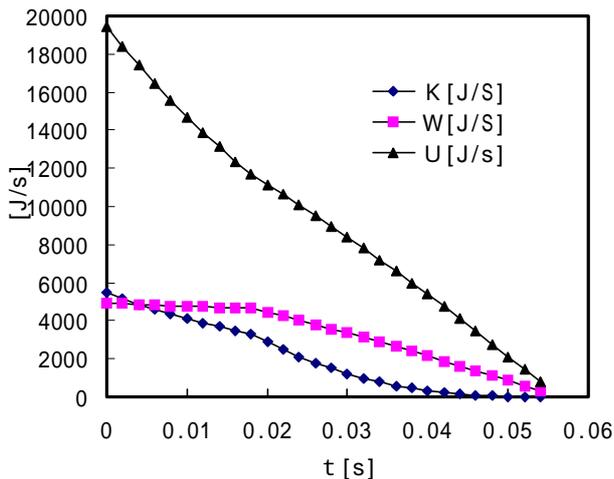
図1.4 運動エネルギーKと大気を押しのける仕事Wと噴出気体の持ち去る内部エネルギーU
