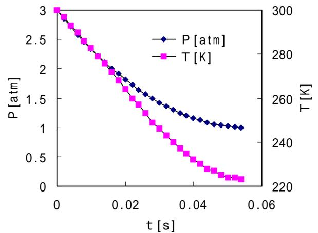
図 1.3 容器内の圧力と温度の変化
