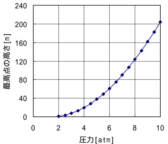
図1.7 初期圧力と最高点の高さ
