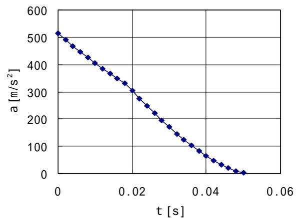
図 1.2 ロケットの加速度の変化
