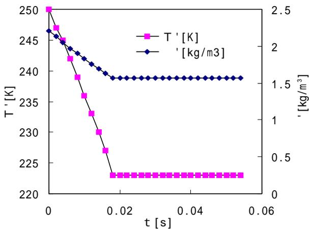
図1.5 噴出気体の密度と温度
