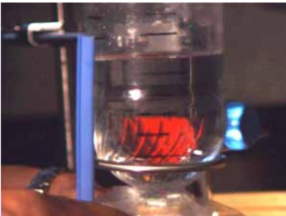
図 12 水の噴射映像(初期圧 2.0atm ,600ml )
